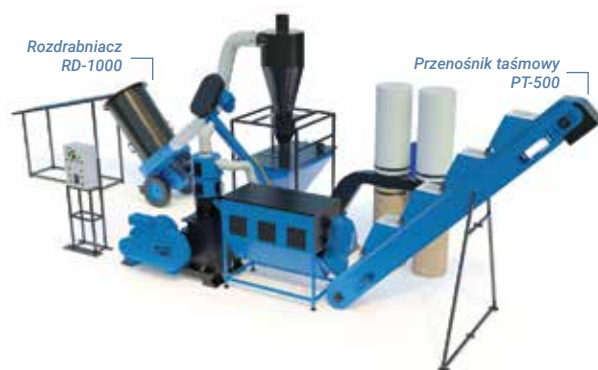
Linia do produkcji pelletu LDG-3000 KOMBI + Przenośnik taśmowy PT-500 + Rozdrabniacz RD-1000 z cyklonem
